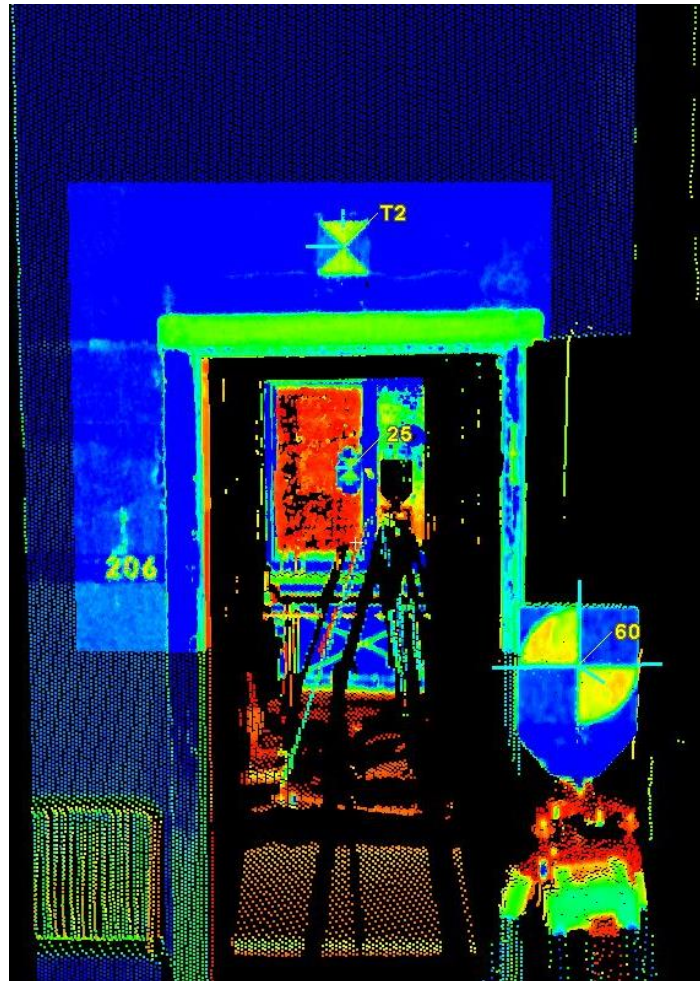
Abbildung 19: Verwendung unterschiedlicher Scan-Auflösungen ("High" / "Super-High")
