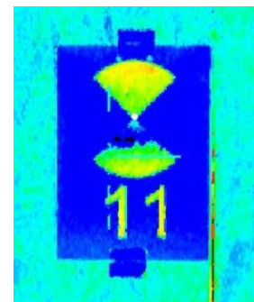
Abbildung 18: Mangelhafte Erkennung des Targets
